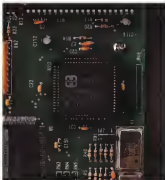
Nella foto sopra si mostra il cuore del computer: un Intel 80286 a 70 MHz, mentre a fianco c'è l'interno del computer completamente schermato.
